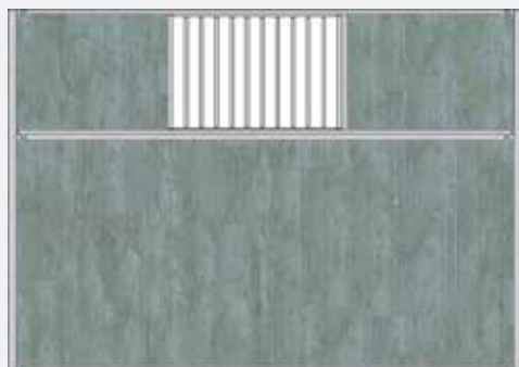
5. Tät mellanvägg med 1 m rakt kontaktgaller.
