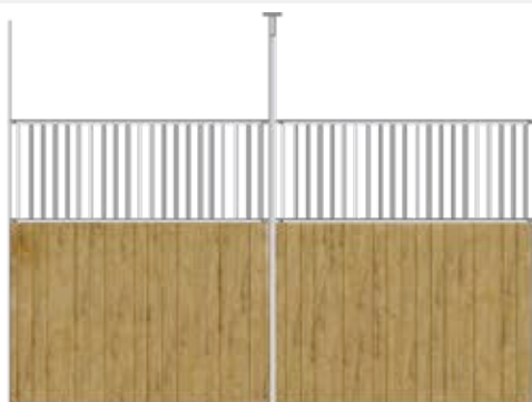
7. Mellanvägg med galleröverdel och skarvstolpe. För extra lång mellanvägg.
